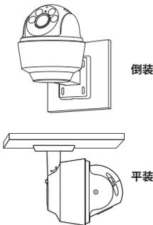
请用户按照说明书方式正确安装，禁止错误方向安装，否则存在因进水导致设备报废风险！
